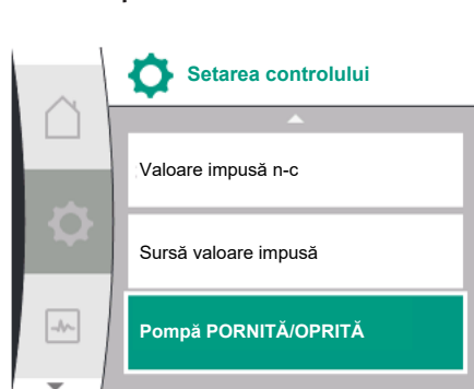
Fig. 46: Setarea controlului pompă PORNIȚĂ/OPRIȚĂ
