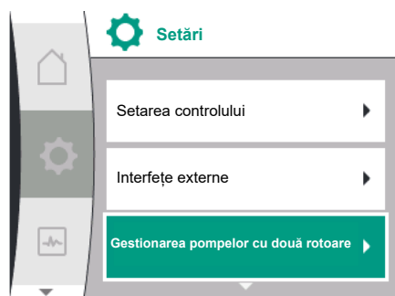
Fig. 48: Meniu gestionarea pompelor cu două rotoare
