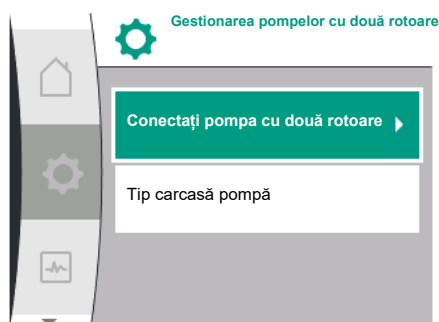
Fig. 49: Meniu gestionarea pompelor cu două rotoare
