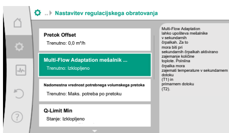
Fig. 59: Nastavitev regulacijskega obratovanja: Multi-Flow Adaptation mešalnik
