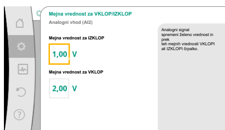
Fig. 80: Mejne vrednosti za krmiljenje VKL./IZKL. prek analognih signalov
