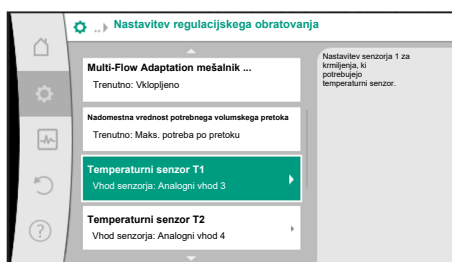
Fig. 61: Multi-Flow Adaptation mešalnik: Temperaturni senzori
