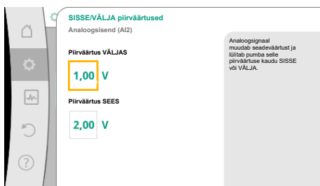
Fig. 80: SISSE/VÄLJA juhtimise piirväärtused analoogsignaali kaudu
