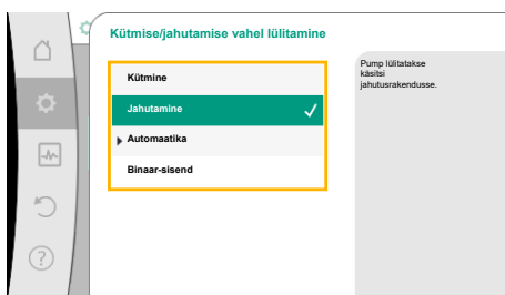
Fig. 49: Kütmise/jahutamise vahel lülitamine_Jahutamine
