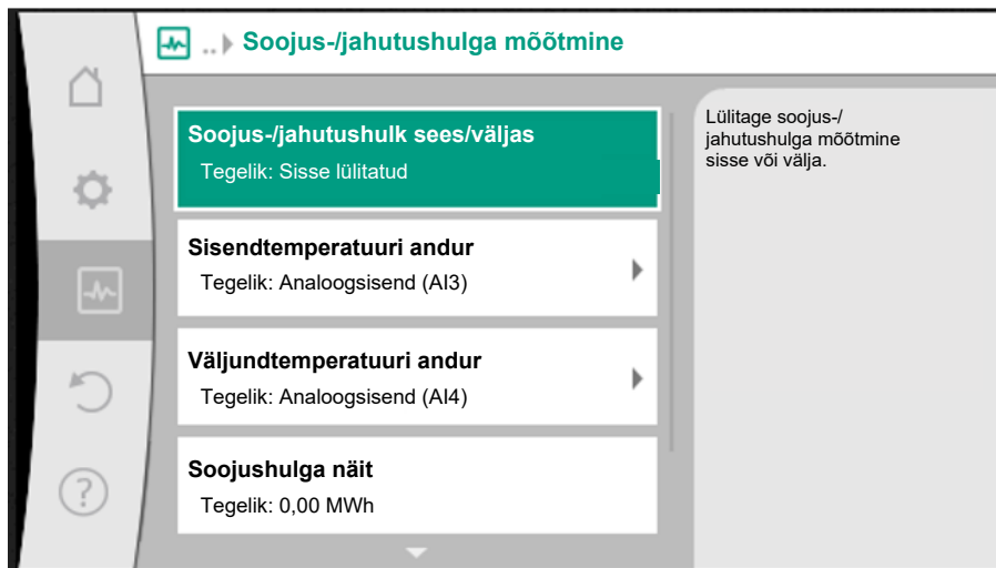
Fig. 92: Soojuse/jahutuse hulga registreerimine
