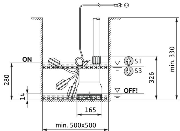
Fig. 3: Drain TMW 32/11: Dimensiones de instalación y puntos de conmutación
