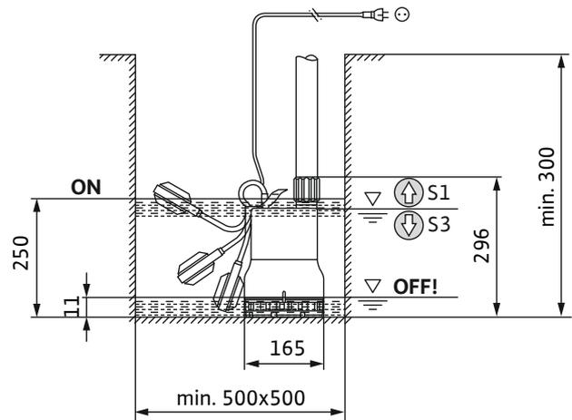
Fig. 2: Drain TMW 32/8: Dimensiones de instalación y puntos de conmutación
