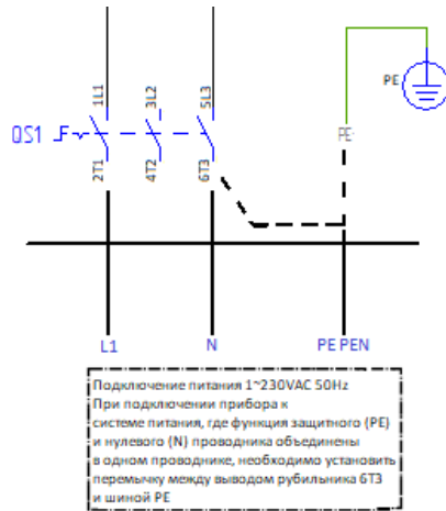
Рис. 12. Подключение прибора к сети 1~230VAC
