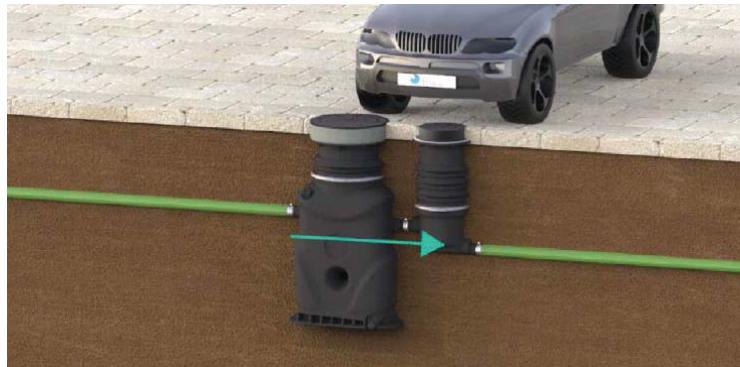
Abbildung: Fettabscheider mit Probenahmeschacht
