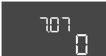
Fig. 73: Włączenie wyświetlacza interwałów serwisowych
