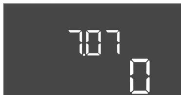
Fig. 73: Attivazione dell'intervallo di manutenzione
