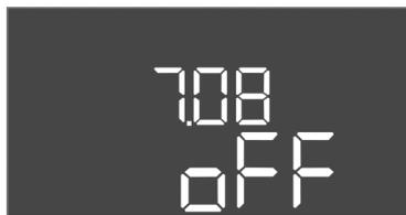
Fig. 74: Disattivazione dell'intervallo di manutenzione
