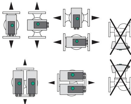
Fig. 2: Lubatud paigaldusasendid
