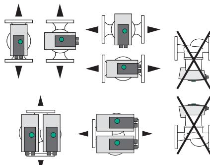
Fig. 2: Допустимые монтажные положения
