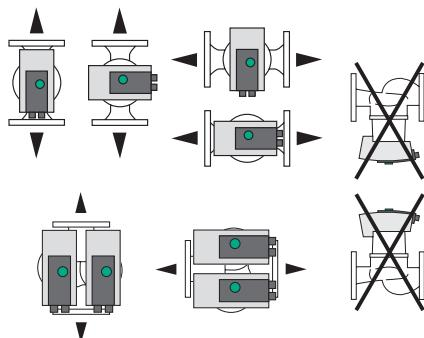
Fig. 2: Dovoljeni vgradni položaji
