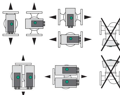
Fig. 2: Dozvoljeni položaji ugradnje
