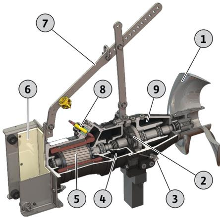
Fig. 2: Vista general del agitador de motor sumergible
