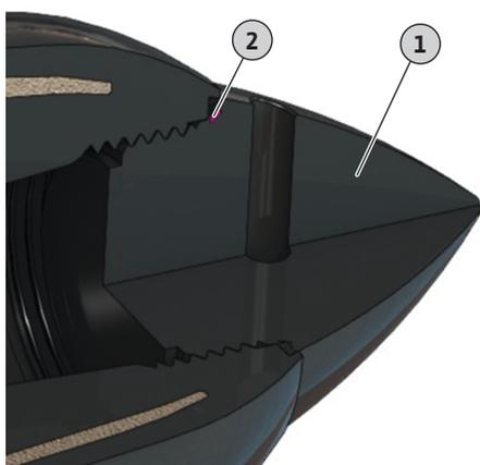
Fig. 18: Tapa del buje con junta tórica
