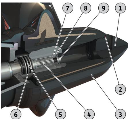
Fig. 16: Cambio de hélice OPTI-TR/EXCEL-TRE 90-2
