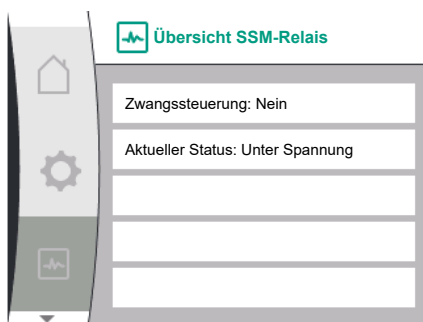
Fig. 39: Übersicht der Relaisfunktion SSM
