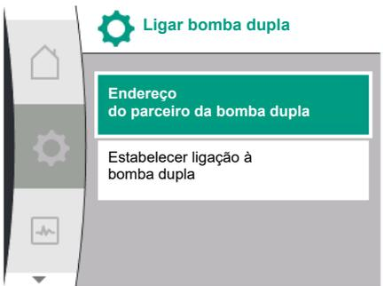
Após configuração dos endereços dos parceiros, o acoplamento da bomba dupla pode ser iniciado ou cancelado através da confirmação no ponto de menu «Estado do acoplamento da bomba dupla».
