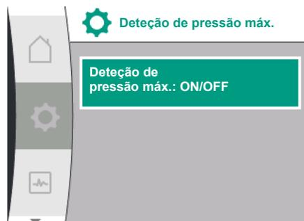
A função de deteção do valor limite da pressão máxima deteta quando a pressão é excedida. A função é necessária para proteger o sistema do cliente para evitar a sobrepresão no lado da pressão. Se a pressão exceder durante 5 segundos um valor limite configurável pelo utilizador, o motor para e será emitida uma mensagem de erro. Se a pressão não atingir este valor limite durante um período de tempo configurável pelo utilizador, o motor volta a reiniciar. Este erro é indicado na HMI.
