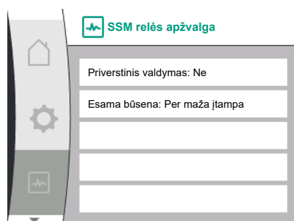
Fig. 39: Relės funkcijos SSM apžvalga
