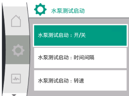
Fig. 37: 水泵测试启动的设置
