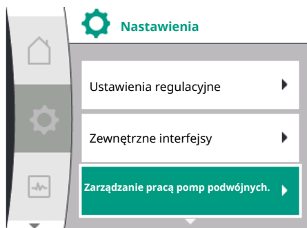
Fig. 50: Menu Zarządzanie pracą pomp podwójnych
