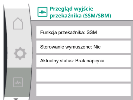
Fig. 90: Przegląd funkcji przekaźnika SSM/SBM
