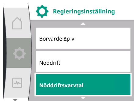
Fig. 71: Menyn Regleringsinställningar med nöddriftsläge vid bortfall av sensorvärdet
