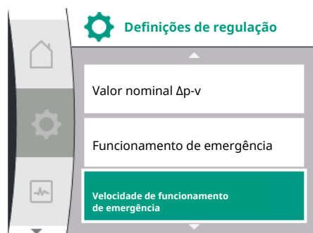
Fig. 46: Regulação da velocidade de funcionamento de emergência
