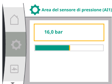
Fig. 69: Impostazione area del sensore di pressione
