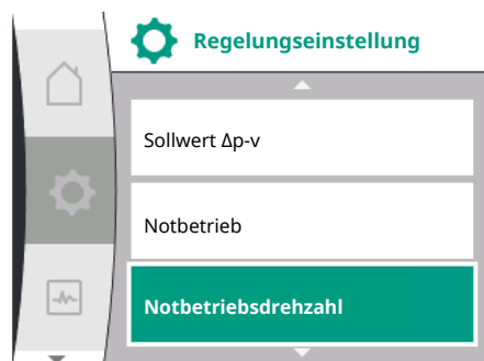
Fig. 71: Menü Regelungseinstellungen mit Notbetriebsmodus bei Ausfall des Sensorwerts
