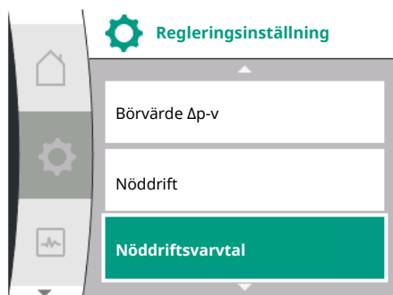
Fig. 46: Inställning av nöddriftsvarvtal
