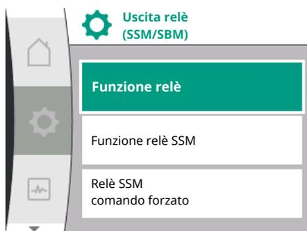
Fig. 61: Menu uscita relè SSM/SBM
