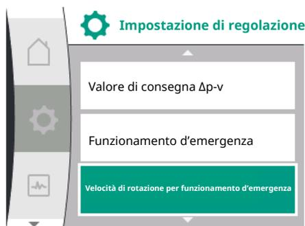
Fig. 71: Menu Impostazioni di regolazione con modalità di funzionamento d'emergenza in caso di mancanza del valore del sensore
