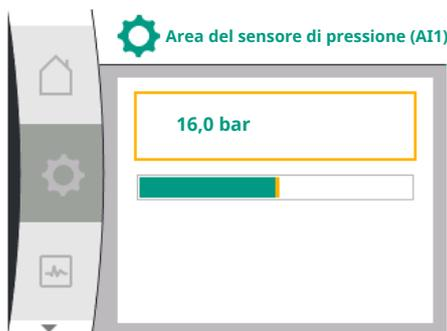
Fig. 69: Impostazione area del sensore di pressione
