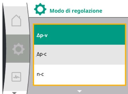
Fig. 41: Selezione del modo di regolazione
