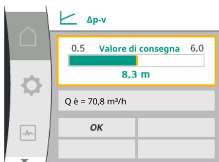
Fig. 34: Regolazione del valore di consegna della schermata principale  $\Delta p-v$
