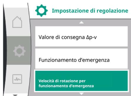
Fig. 46: Impostazione velocità di rotazione per funzionamento d'emergenza
