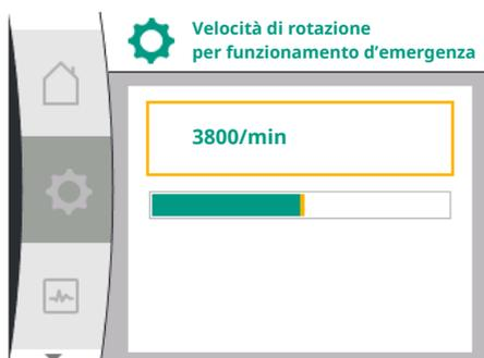
Fig. 47: Velocità di rotazione per funzionamento d'emergenza
