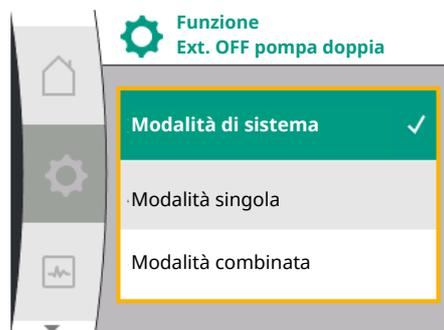
Fig. 66: Modalità selezionabili per EXT. OFF con pompa doppia
