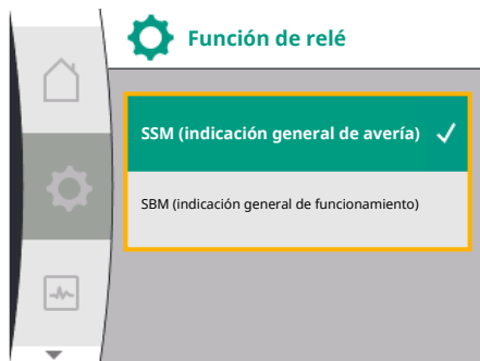
Fig. 62: Menú Función de salida de relé SSM/SBM
