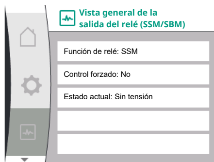
Fig. 90: Vista general de la función del relé SSM/SBM
