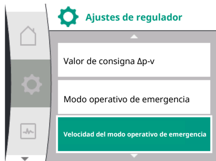
Fig. 71: Menú Ajustes de regulador con modo operativo de emergencia en caso de avería del valor del sensor
