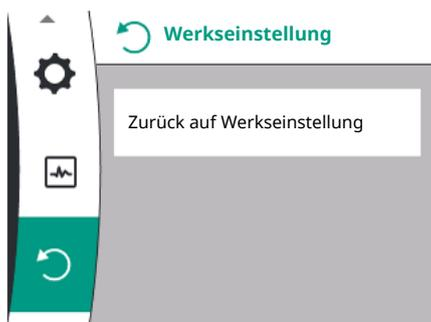
Fig. 97: Zurücksetzen auf Werkseinstellung
