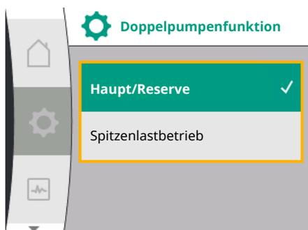
Fig. 55: Menü Doppelpumpenfunktion
