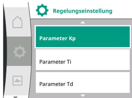
Fig. 43: Einstellung PID-Parameter
