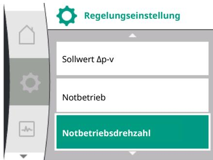
Fig. 46: Einstellung Notbetriebsdrehzahl
