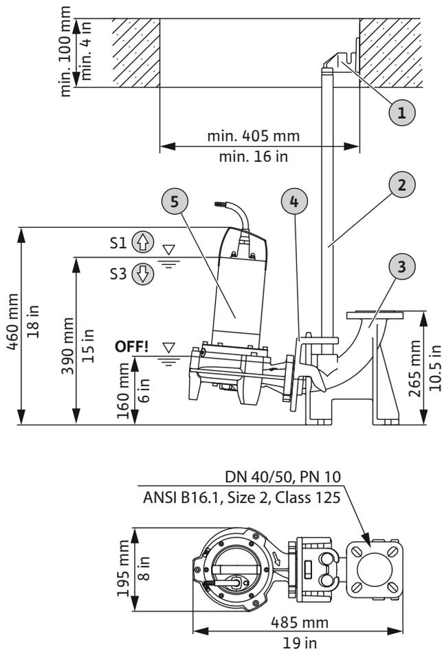
Fig. 2: Επισκόπηση των εξαρτημάτων και των διαστάσεων εγκατάστασης
