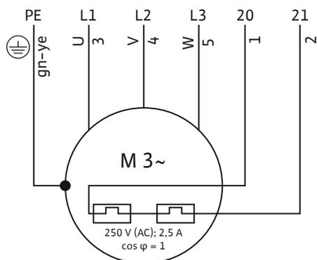
Fig. 7: Schéma de raccordement moteur 3~
