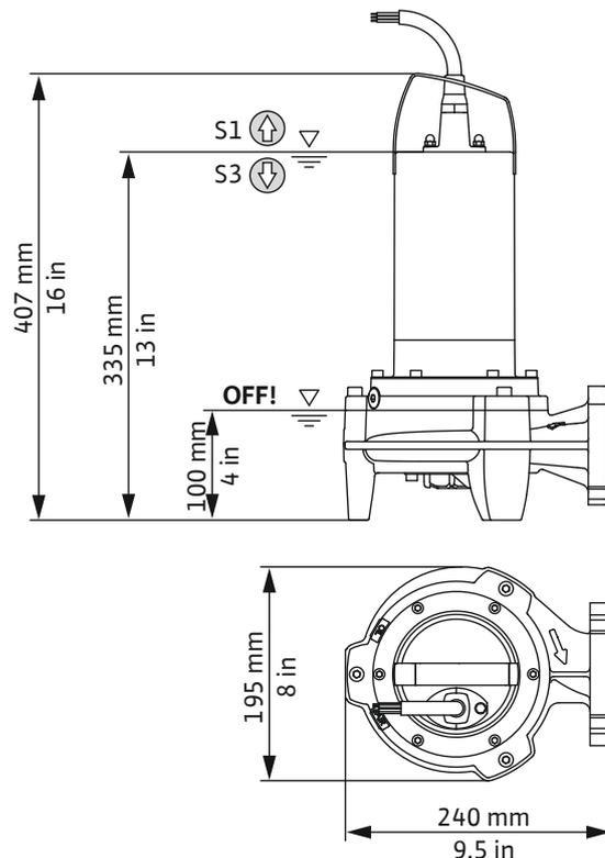
Fig. 3: Dimensões de instalação
