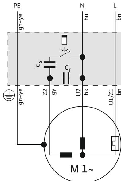
Fig. 4: Esquema de ligações para motor monofásico
