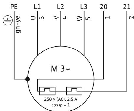
Fig. 5: Esquema de ligações para motor trifásico
