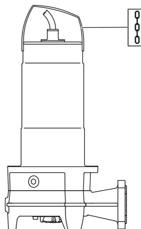
Fig. 1: Ponto de fixação
