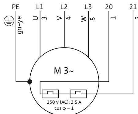
Fig. 7: Esquema de ligações para motor trifásico
