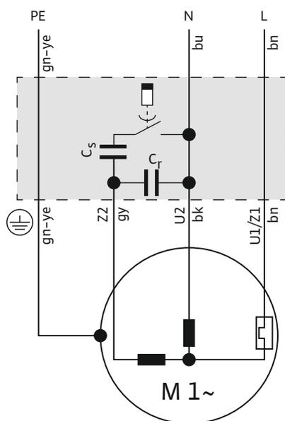
Fig. 6: Esquema de ligações para motor monofásico
