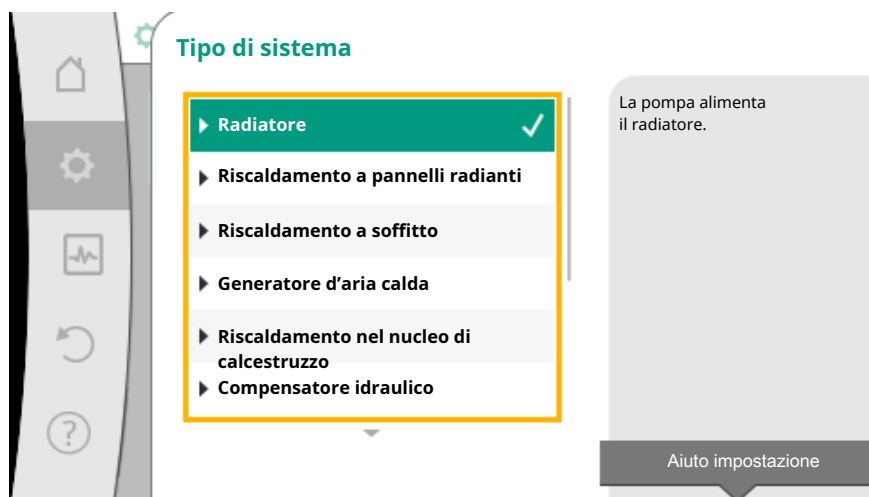
Fig. 41: Esempio tipo di sistema "Radiatore"
