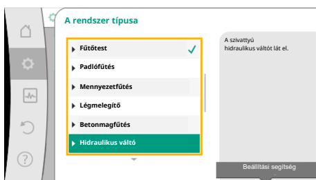
Fig. 54: „Hidraulikus váltó” rendszertípus
