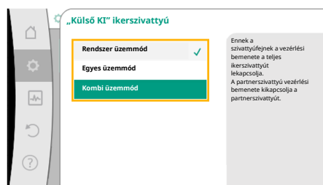
Fig. 65: Választható üzemmódok EXT. OFF esetén ikerszivattyúkhöz
