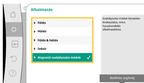
Fig. 4.4: „Alapvető szabályozási módok” alkalmazásválasztás
