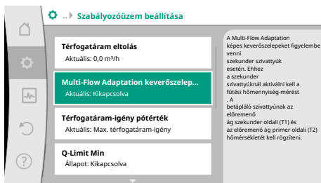
Fig. 59: Szabályozóüzem beállítása: Multi-Flow Adaptation keverőszelep
