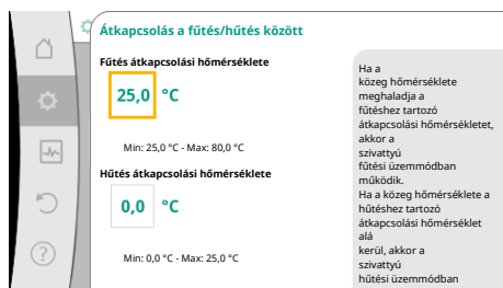
Fig. 51: Átkapcsolás a fűtés/hűtés között_Átkapcsolási hőmérsékletek
