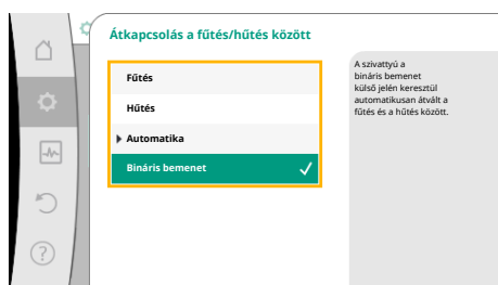
Fig. 52: Átkapcsolás a fűtés/hűtés között_Bináris bemenet
