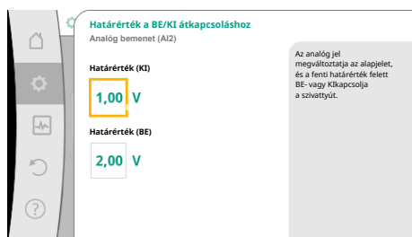
Fig. 79: Az analóg jelekkel végzett BE/KI vezérlés határértékei
