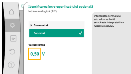
Fig. 77: Valoare limită cablu rupt
