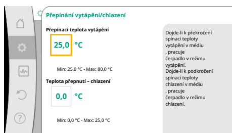
Fig. 51: Přepínání vytápění/chlazení_teploty přepnutí
