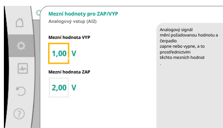
Fig. 79: Mezní hodnoty pro řízení zap/vyp prostřednictvím analogových signálů
