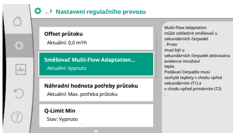
Fig. 59: Nastavení regulačního režimu: Směšovač Multi-Flow Adaptation
