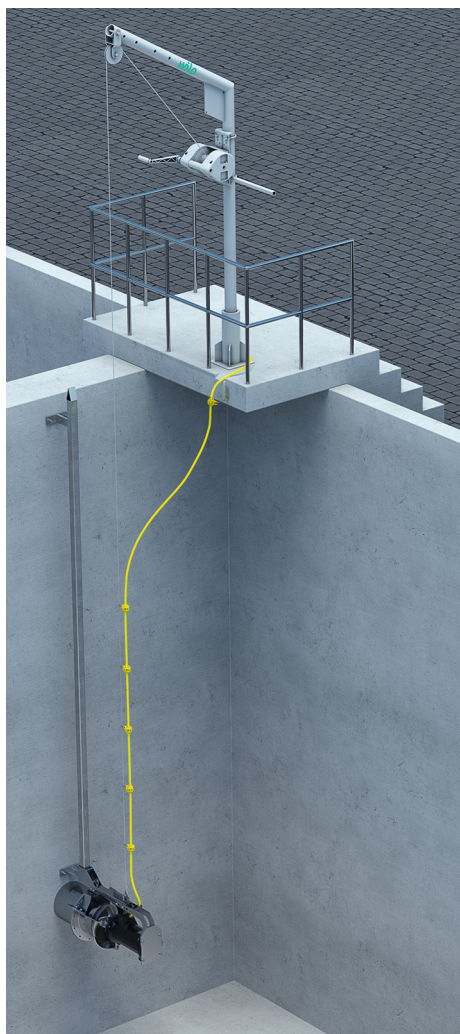
Fig. 6: Instalação com dispositivo de abaixamento
