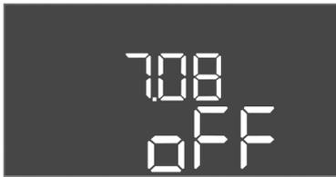
Fig. 74: Disattivazione dell'intervallo di manutenzione
