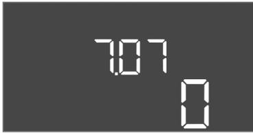
Fig. 73: Attivazione dell'intervallo di manutenzione
