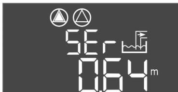
Fig. 72: Indicación intervalo de mantenimiento
