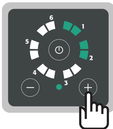
→ Per impostare la pressione di esercizio su 3 bar, per esempio, premere due volte il pulsante “+”. Il valore viene aumentato di 1 bar (0,5 + 0,5 bar).
