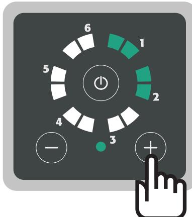
→ Stiskněte například dvakrát tlačítko „+“ pro zvýšení provozního tlaku na 3 bar.
