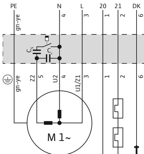
Fig. 8: Schéma de raccordement du moteur monophasé
