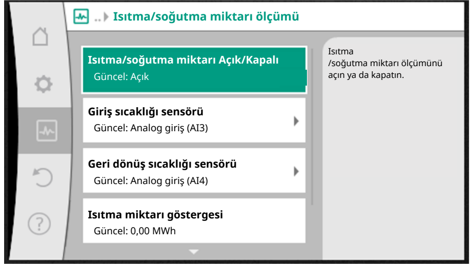
Fig. 91: Isıtma/soğutma miktarı algılama
