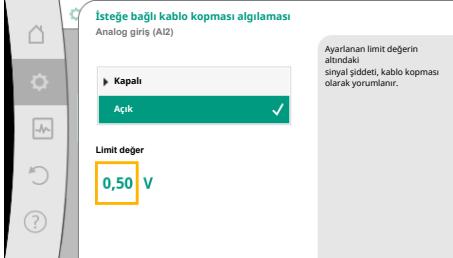
Fig. 77: Limit değeri kablo kopması
