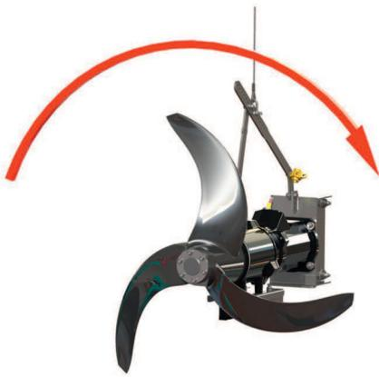
**INDICAÇÃO!** Sentido de rotação inverso em mecanismos agitadores do tipo TRE 312! Visto de frente, o mecanismo agitador roda no sentido horário, visto de trás, roda no sentido anti-horário.
