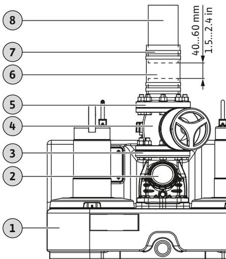
Fig. 3: Druckanschluss anbringen
