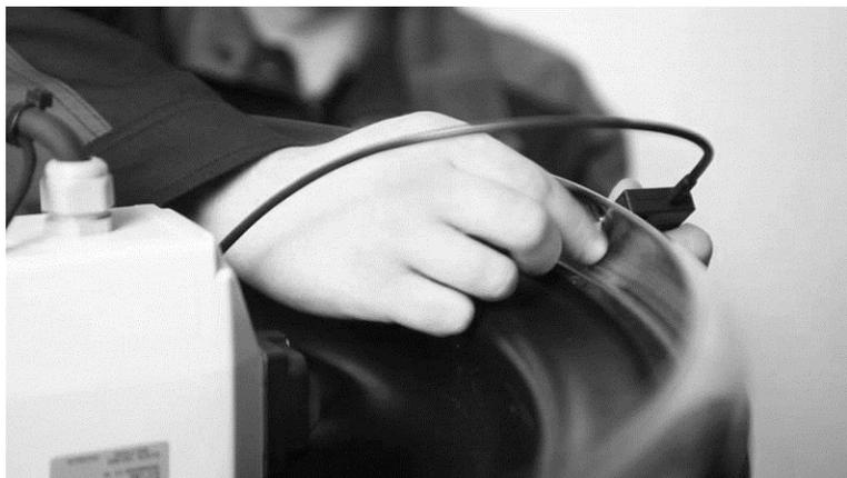
6) Spannring montieren
