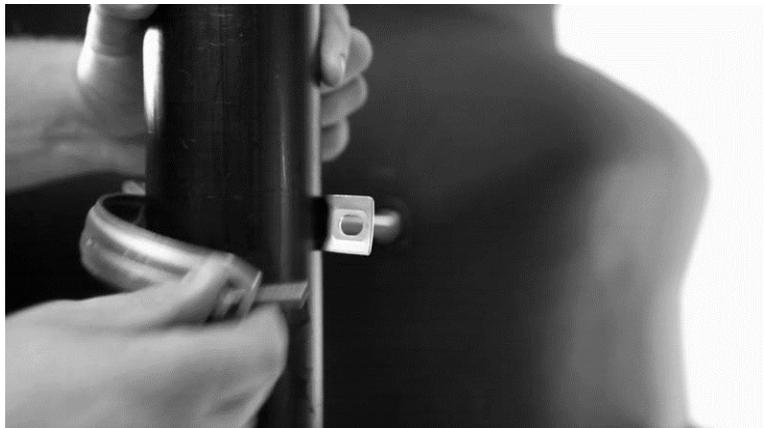
6) Gelenkbolzenschelle an der Saugleitung festziehen
