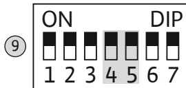
Fig. 18: DIP şalteri 2: Servis aralığı göstergesi
