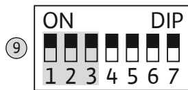
Fig. 19: DIP-spínač 2: Monitorovanie prevádzkových parametrov
