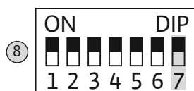
Fig. 16: Întrerupător DIP 1: sonerie internă
