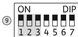
Fig. 19: Interruptor DIP 2: Monitorização dos parâmetros de funcionamento
