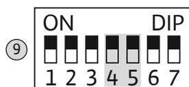
Fig. 18: Interruptor DIP 2: Indicação do intervalo de manutenção
