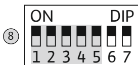
Fig. 9: DIP-bryter 1: Innstille motorstrømovervåkning
