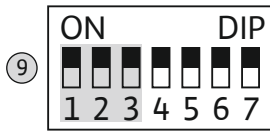
Fig. 19: DIP-bryter 2: Overvåkning av driftsparametrene
