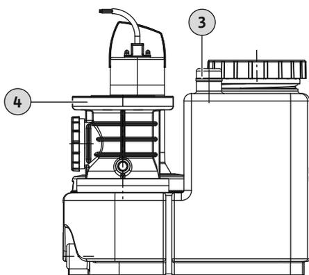
Fig. 6: Raccord de purge du réservoir collecteur
