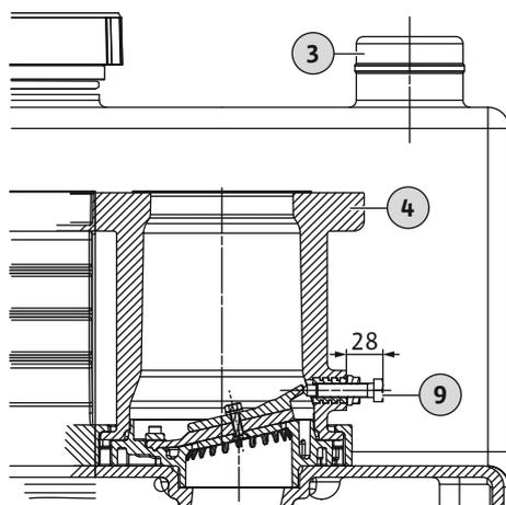
Fig. 8: Position du bouchon de purge d'air
