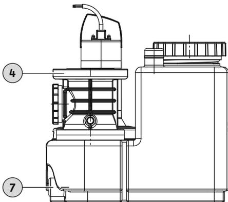
Fig. 7: Conexión de la bomba manual de membrana
