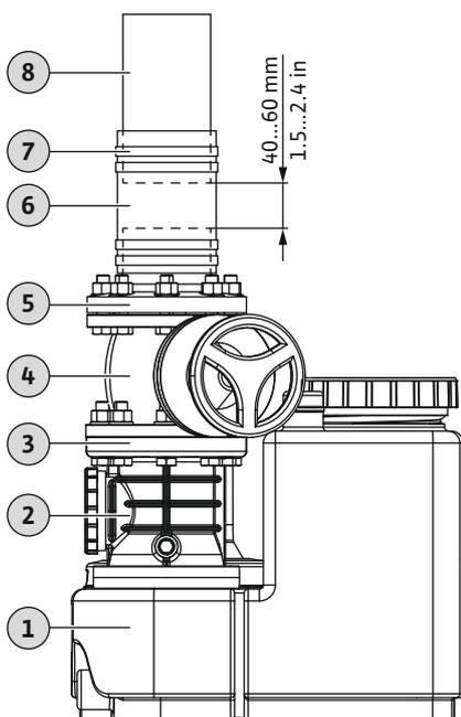
Fig. 3: Montaje de la conexión de impulsión
