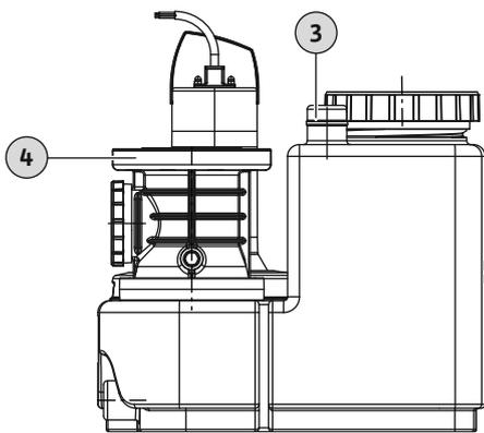
Fig. 6: Conexión de purga del depósito colector
