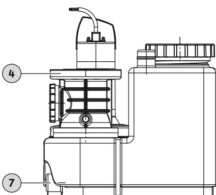
Fig. 7: Подсоединение ручного мембранных насоса
