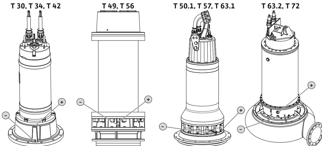
Fig. 16: Cámara de separación: Cambio de aceite
