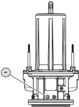
Fig. 17: Vaciado de la cámara de fugas: T 20.1
