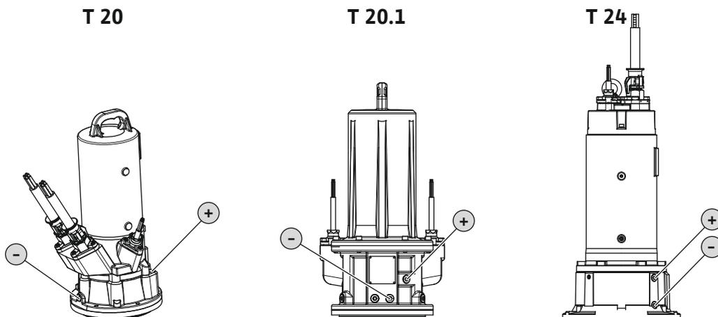
Fig. 9: Cámara de separación: Comprobar el aceite
