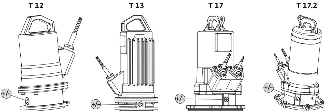
Fig. 14: Cámara de separación: Cambio de aceite
