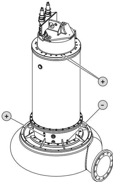
Fig. 22: Volver a lubricar el rodamiento de bolas: T 72
