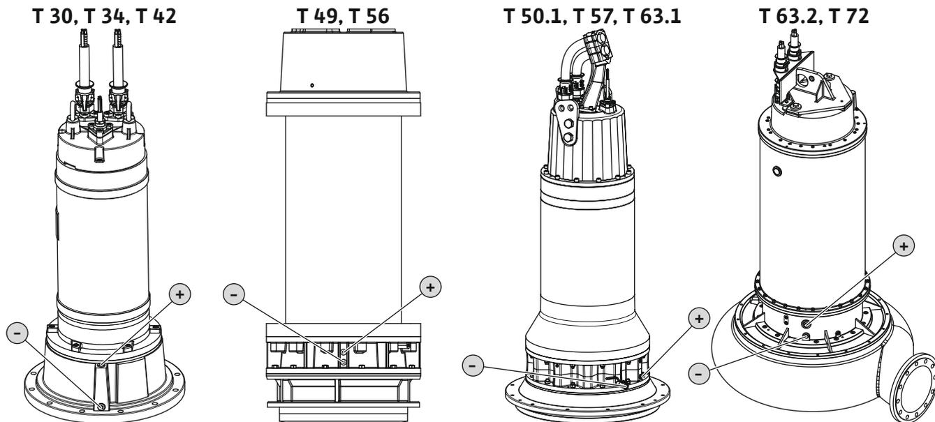
Fig. 10: Cámara de separación: Comprobar el aceite
