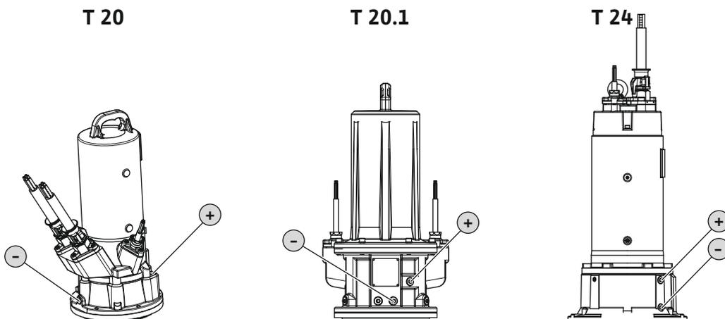
Fig. 15: Cámara de separación: Cambio de aceite
