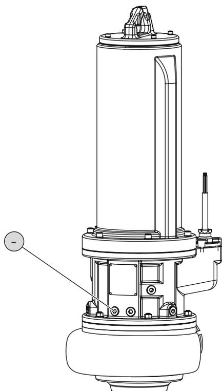
Fig. 9: Leckagekammer entleeren
