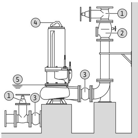
Fig. 8: Trockenaufstellung
