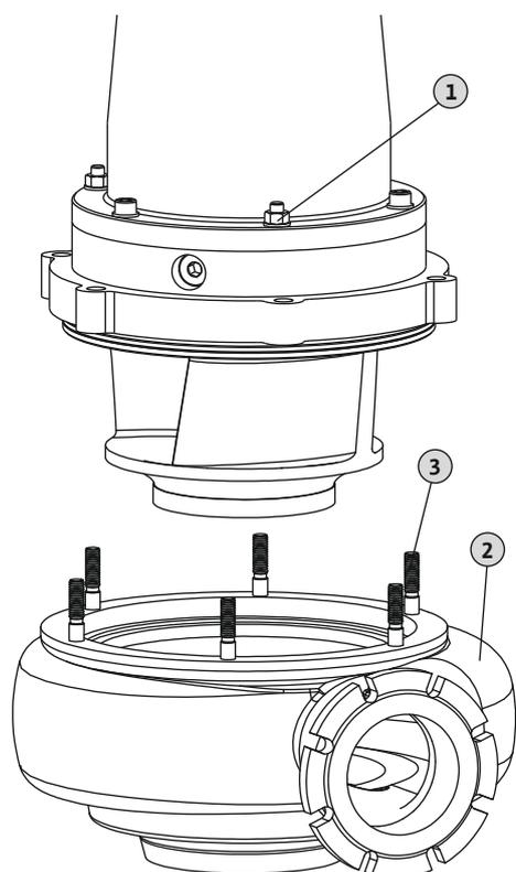
Fig. 12: Hydraulikgehäuse wechseln
