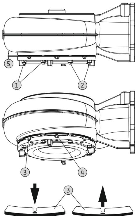
Fig. 16: SOLID G: Nastavenie rozmeru medzery
