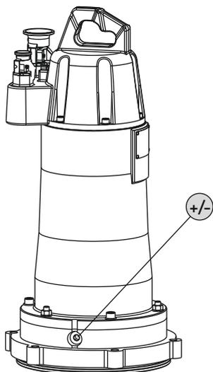
Fig. 4: Priestor motora: Kontrola oleja
