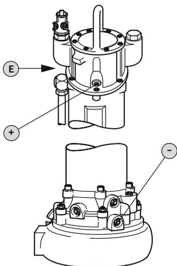
Fig. 5: Priestor motora: Kontrola oleja
