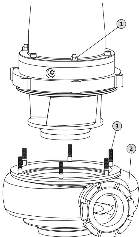
Fig. 15: Výmena telesa hydrauliky
