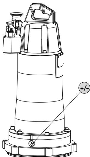
Fig. 11: Priestor motora: Výmena oleja
