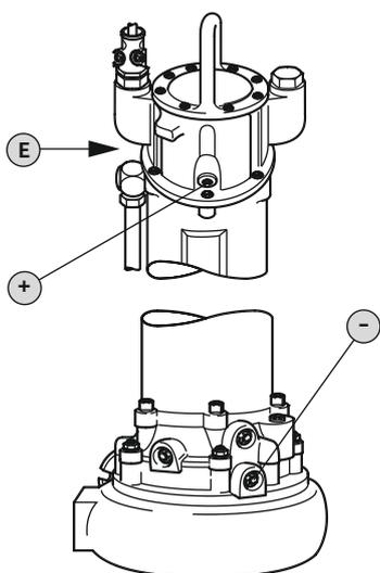
Fig. 12: Priestor motora: Výmena oleja
