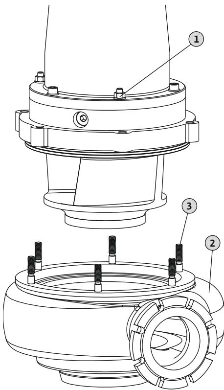
Fig. 15: Înlocuirea carcasei sistemului hidraulic
