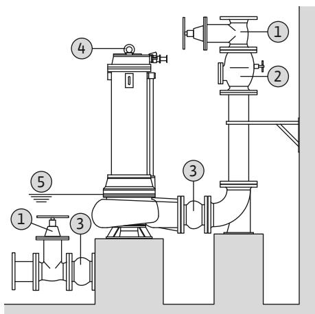
Fig. 10: Montare în spațiu uscat
