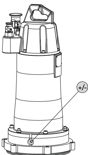
Fig. 11: Compartimentul motorului: Schimb de ulei
