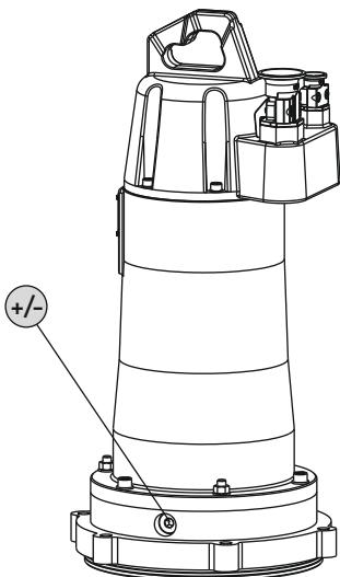
Fig. 13: Camera de etanșare: Schimb de ulei
