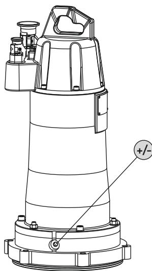
Fig. 4: Compartimentul motorului: Verificarea uleiului
