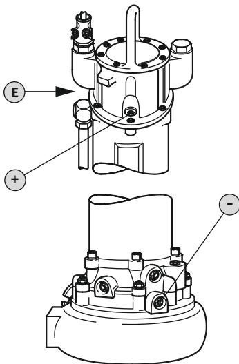
Fig. 5: Compartimentul motorului: Verificarea uleiului
