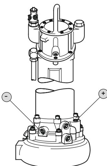
Fig. 7: Camera de etanșare: Verificarea uleiului
