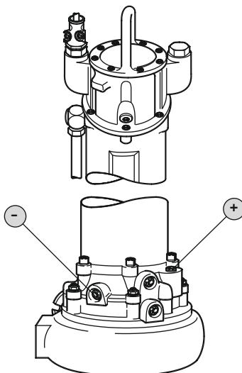
Fig. 14: Camera de etanșare: Schimb de ulei
