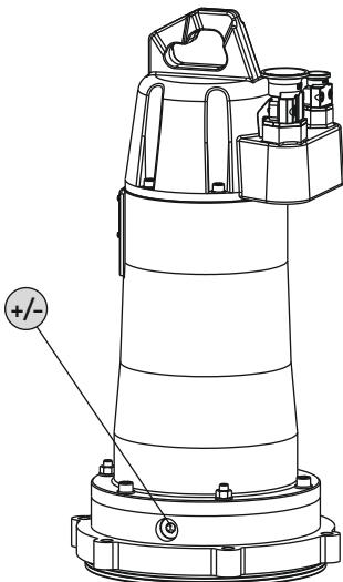
Fig. 6: Camera de etanșare: Verificarea uleiului
