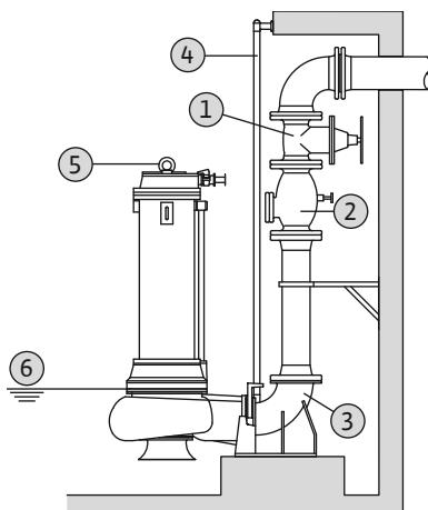
Fig. 8: Montare imersată staționară
