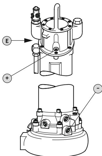
Fig. 12: Compartimentul motorului: Schimb de ulei
